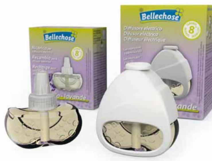
Questo diffusore è una novità. Diffusore elettrico di profumo per ambienti. Evaporazione forzata tramite mesh riscaldata da una resistenza elettrica. Adatto a profumi liquidi a base alcolica. Composto da diffusore in PP e PA, da flacone di ricarica da 20/25ml in vetro o PVC con portamesh in PE e tappo di serraggio in PP. Il diffusore ha la spina d'innesto ruotabile di 180°.
