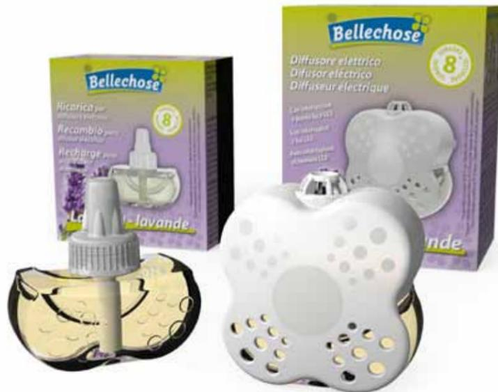
Diffusore elettrico di profumo per ambienti. Evaporazione forzata tramite mesh riscaldata da una resistenza elettrica. Adatto a profumi liquidi a base alcolica. Composto da diffusore in PP e PA, da flacone di ricarica da 20/25ml in vetro o PVC con portamesh in PE e tappo di serraggio in PP. Il diffusore ha la spina d'innesto ruotabile di 180°, può essere fornito con o senza interruttore di accensione/spegnimento e LED interni che diffondono una piacevole luce soffusa.
